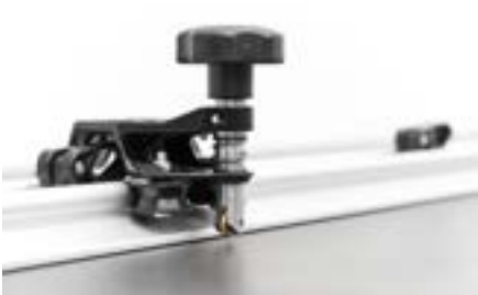
Si raccomanda di usare strumenti professionali: una guida di taglio provvista di ventose incorporate e di incisore con rotellina in titanio.
