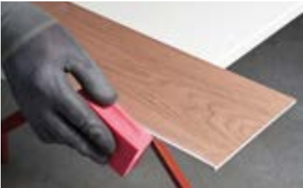
Rifinire i bordi tagliati a vivo con tamponi o dischi diamantati.
