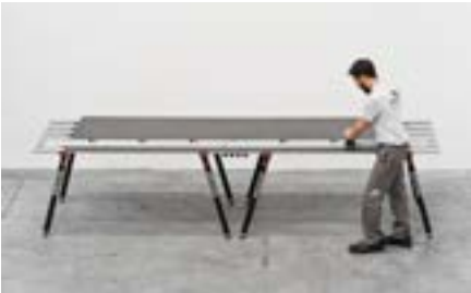
È importante utilizzare un piano perfettamente stabile e planare per effettuare le operazioni di taglio.
