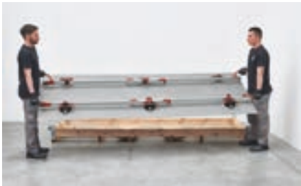
Pulire la superfice della lastra, all'interno della cassa o sul cavalletto prima di utilizzare il telaio per la movimentazione.
